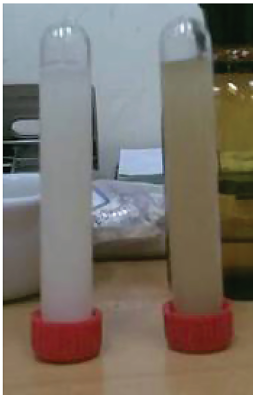
شکل ۲- نمونه غیر قابل قبول و نمونه قابل قبول در مرحله حذف کلسیم و سایر مهارکننده‌ها ( به ترتیب از راست به چپ).
